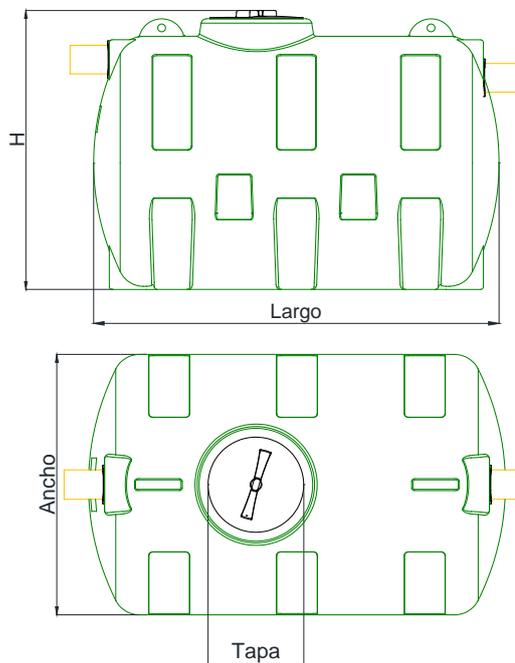
**Descripción:** Fabricados en Polietileno de Alta Densidad (PEAD), según la norma UNE-EN 1825. Accesorios y tubería en PVC sanitario. Amplia variedad de modelos. Disponibilidad de modelos de pequeño tamaño para colocar en superficie bajo fregadero (SGS).
